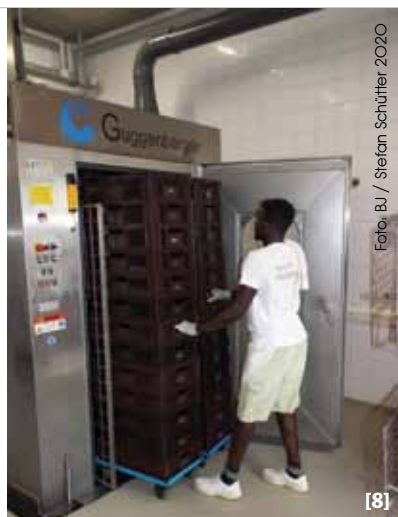
[7] Mit Programm 5 und 20 Minuten Waschdauer werden auch Schnittenbleche ohne weitere Vorreinigung wieder sauber, wenn zuvor grobe Kuchenreste entfernt wurden. [8] Pro Waschgang passen 4 Rollis mit je 13 übereinander gestapelten Körben im 60x40 Euromaß gleichzeitig in die Kammer der HSA 2000 Eco. [9] Von den Lagerstikken kommen immer zwei gleichzeitig in die Waschkammer. Von den Ofenstikken auch, dann ist aber der Einsatz von Reinigungsmittel erforderlich. [10] In der Waschkabine befindet sich ein Käfigkarussell auf einem Drehteller. Ist es mit Waschgut gefüllt, werden die Gittertüren geschlossen und mit einem Bügel gesichert.
