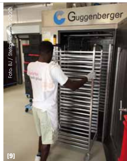
[7] Mit Programm 5 und 20 Minuten Waschdauer werden auch Schnittenbleche ohne weitere Vorreinigung wieder sauber, wenn zuvor grobe Kuchenreste entfernt wurden. [8] Pro Waschgang passen 4 Rollis mit je 13 übereinander gestapelten Körben im 60x40 Euromaß gleichzeitig in die Kammer der HSA 2000 Eco. [9] Von den Lagerstikken kommen immer zwei gleichzeitig in die Waschkammer. Von den Ofenstikken auch, dann ist aber der Einsatz von Reinigungsmittel erforderlich. [10] In der Waschkabine befindet sich ein Käfigkarussell auf einem Drehteller. Ist es mit Waschgut gefüllt, werden die Gittertüren geschlossen und mit einem Bügel gesichert.
